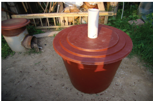
8. 배기관 순환통 설치 뚜껑을 열기 힘들어서 배기관을 고무통 윗부분에서 절단하고 연결밸브를 끼운 후 다시 배기통을 끼워서 작업하는 것으로 수정했다.
