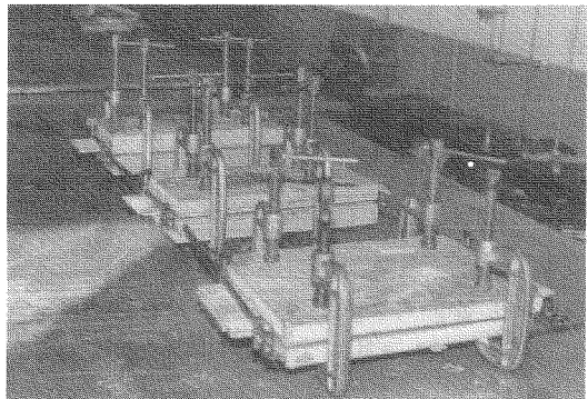
그림 13. 맹종죽 스트립의 압채(clamping)
