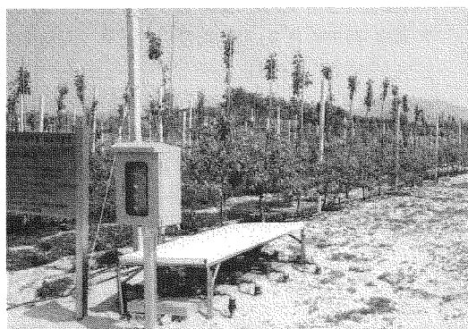
Fig. 1. 이로메타를 이용한 자동 관수시설
